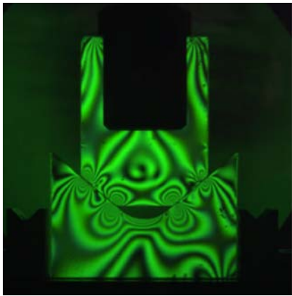
图 5 40^{\circ} 倾斜接触光弹试验
